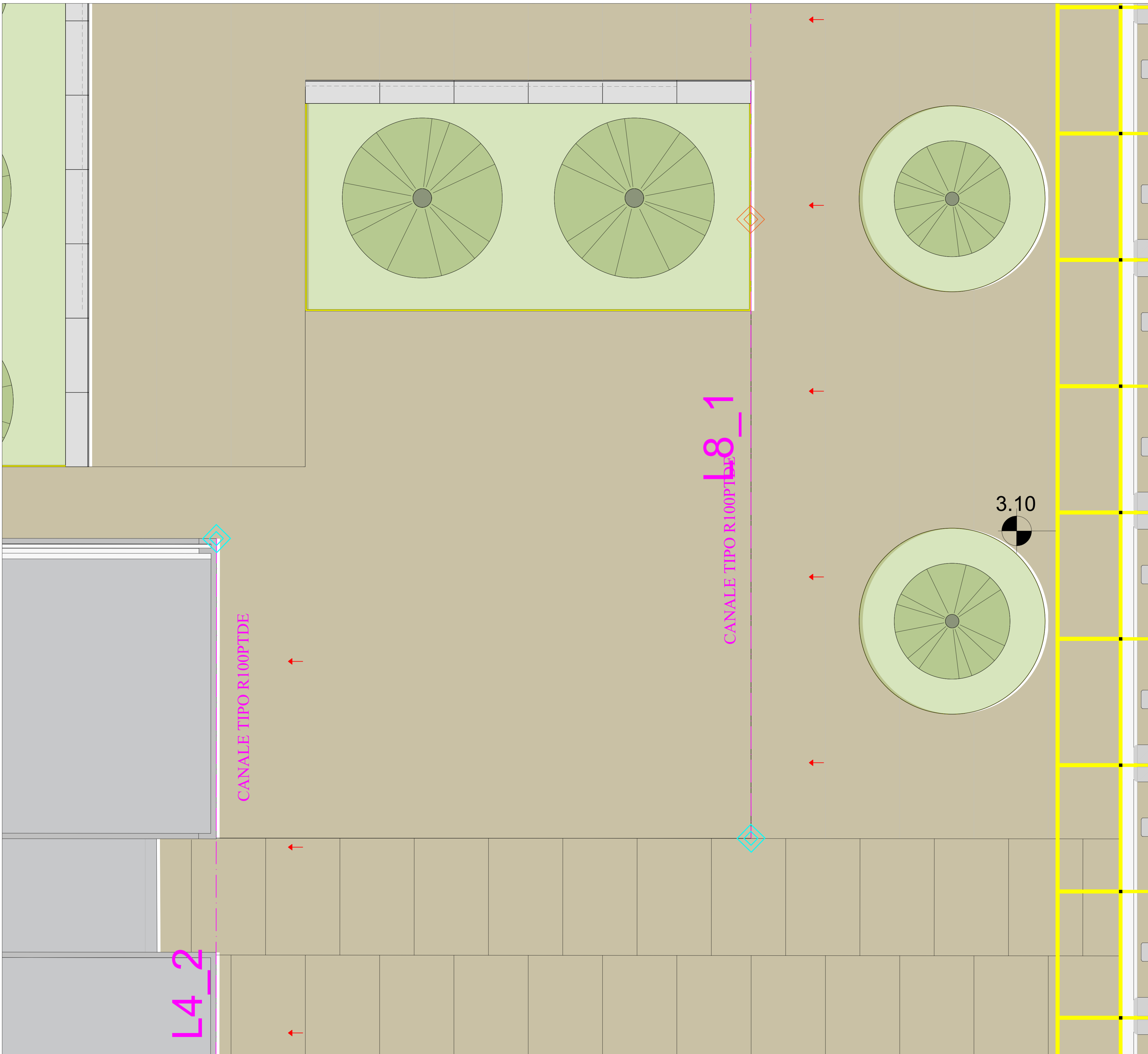
Canale lineare per la raccolta delle acque piovane a fessura sottile. Minimo impatto visivo Massima captazione delle acque piovane
